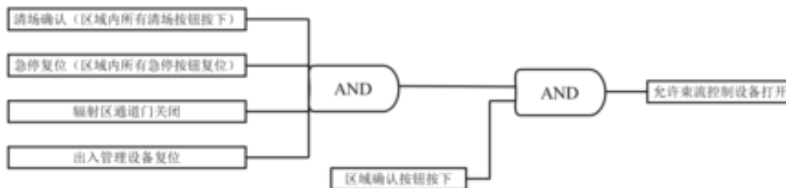
图 4-35 加速器大厅及高能束运线大厅区域人身安全联锁系统主要联锁逻辑
