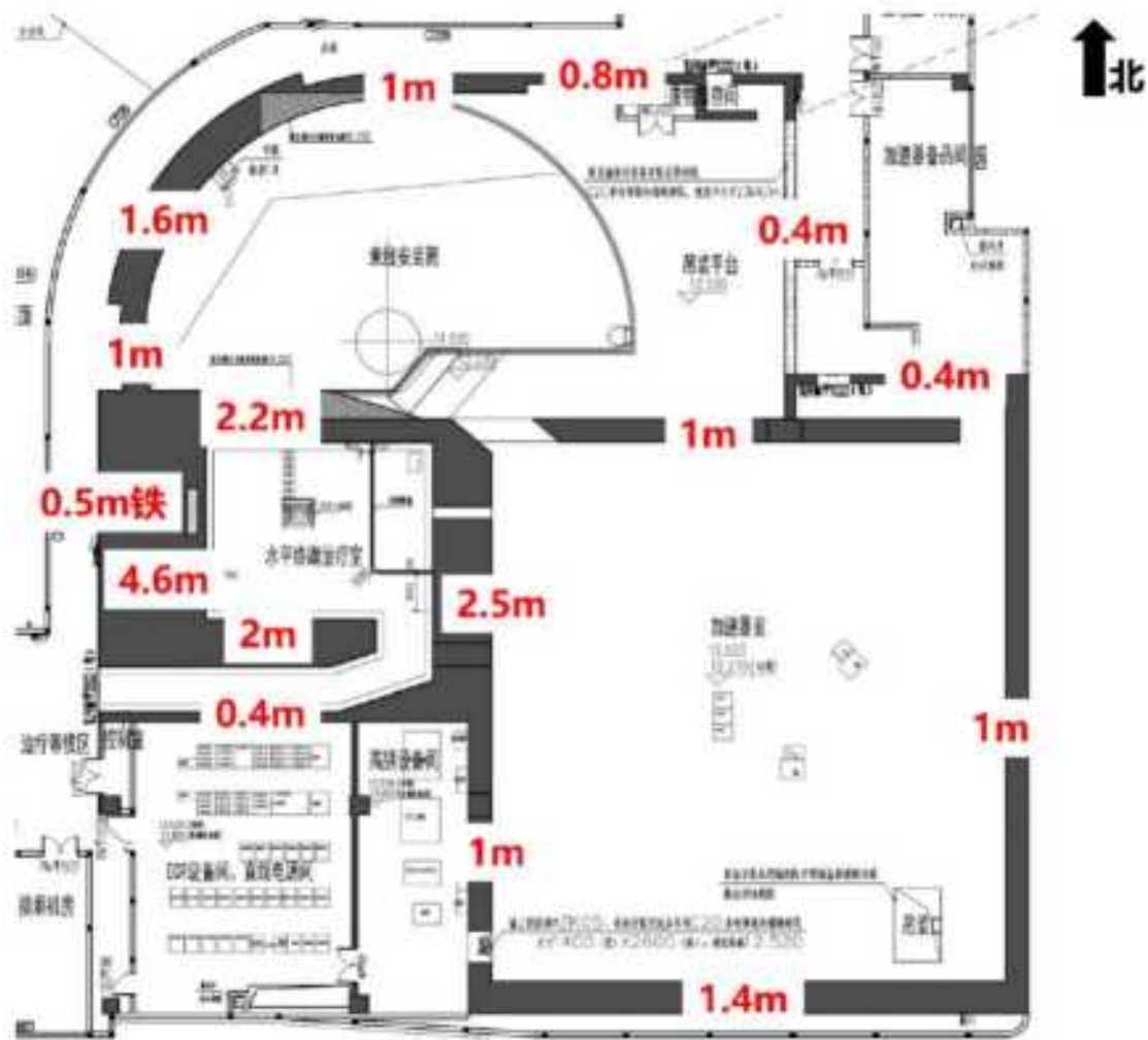
图 4-10 惠州重离子医学中心项目地上三层屏蔽结构平面示意图
