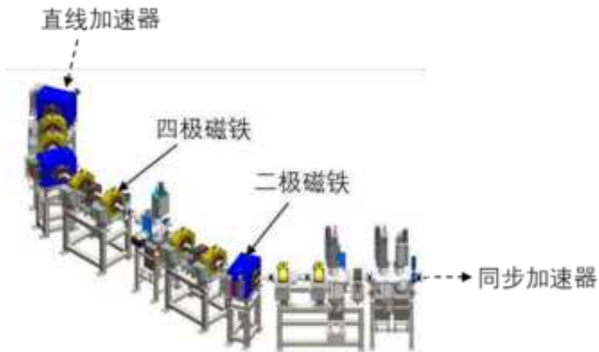
图 3-11 注入线系统布局图
