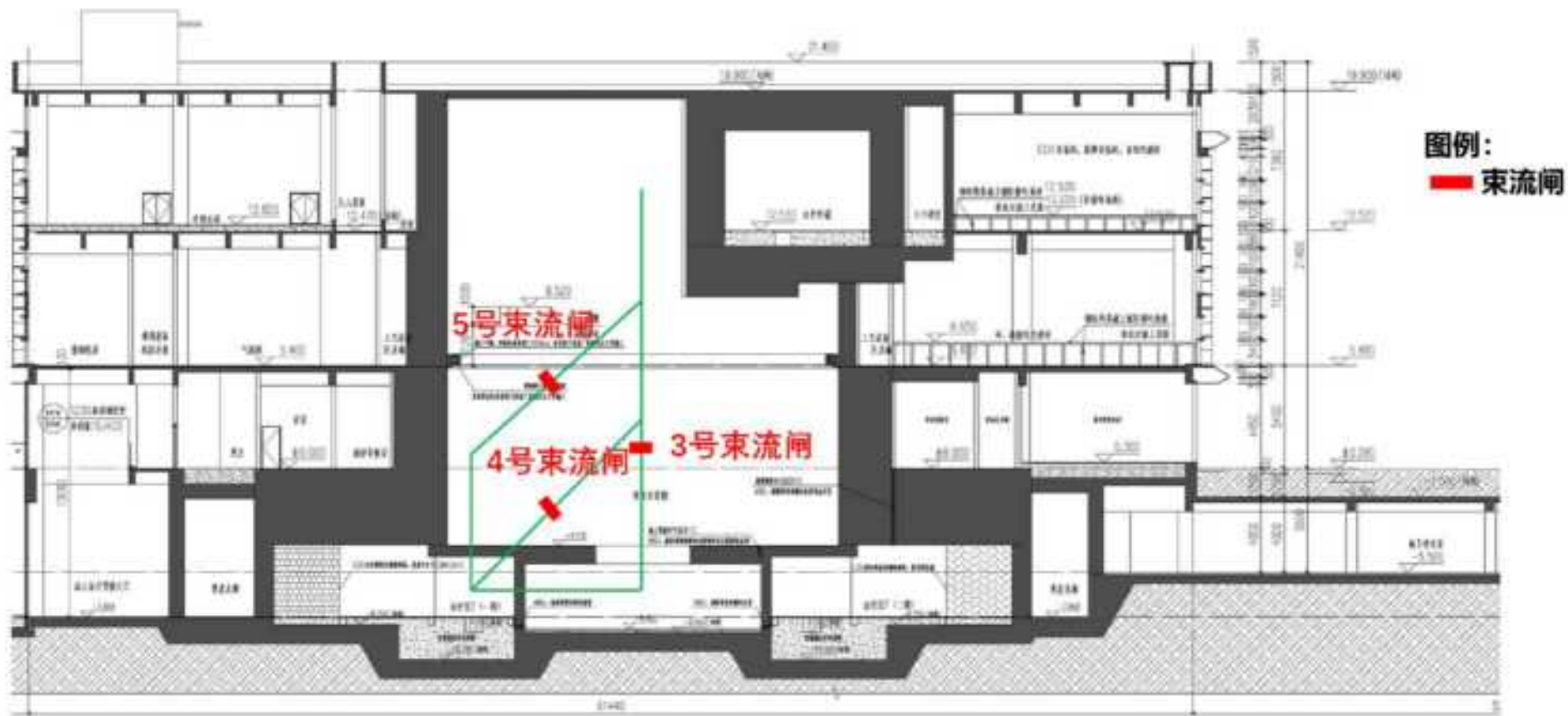
图 4-33 辐射安全联锁设施安装点位剖面图
