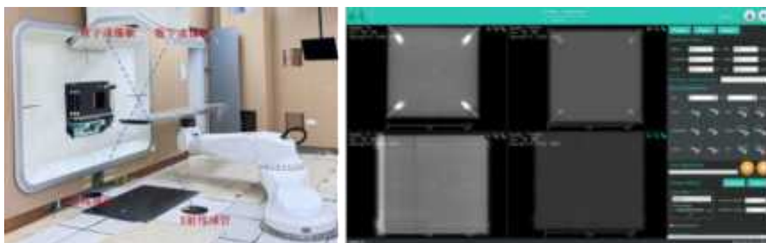
图 3-16 放射治疗用 X 射线图像引导系统示意图 (DR)
